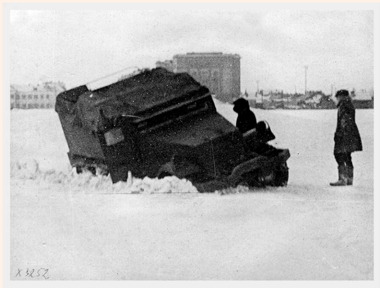
Мы испытываем Уайт (гусеница соскочила)
