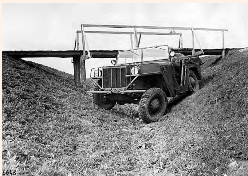
Проверка взаимных перекосов мостов автомобиля АР-НАТИ. Весна 1941 г.
