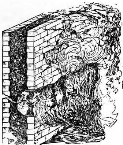
Рис. 98. Разрушение стен собора (реконструкция).
