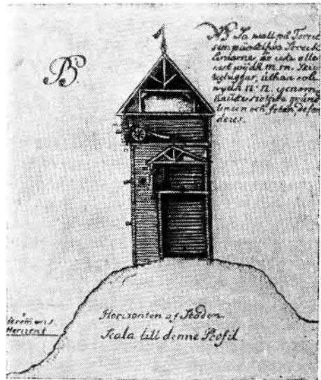
Рис. 20. Разрез деревянной городской стены и башни.
