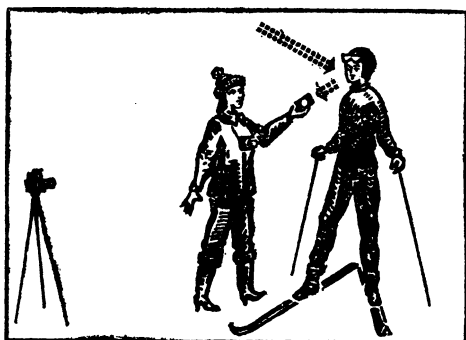
Рис. V.2. Измерение освещенности по способу яркости участка
